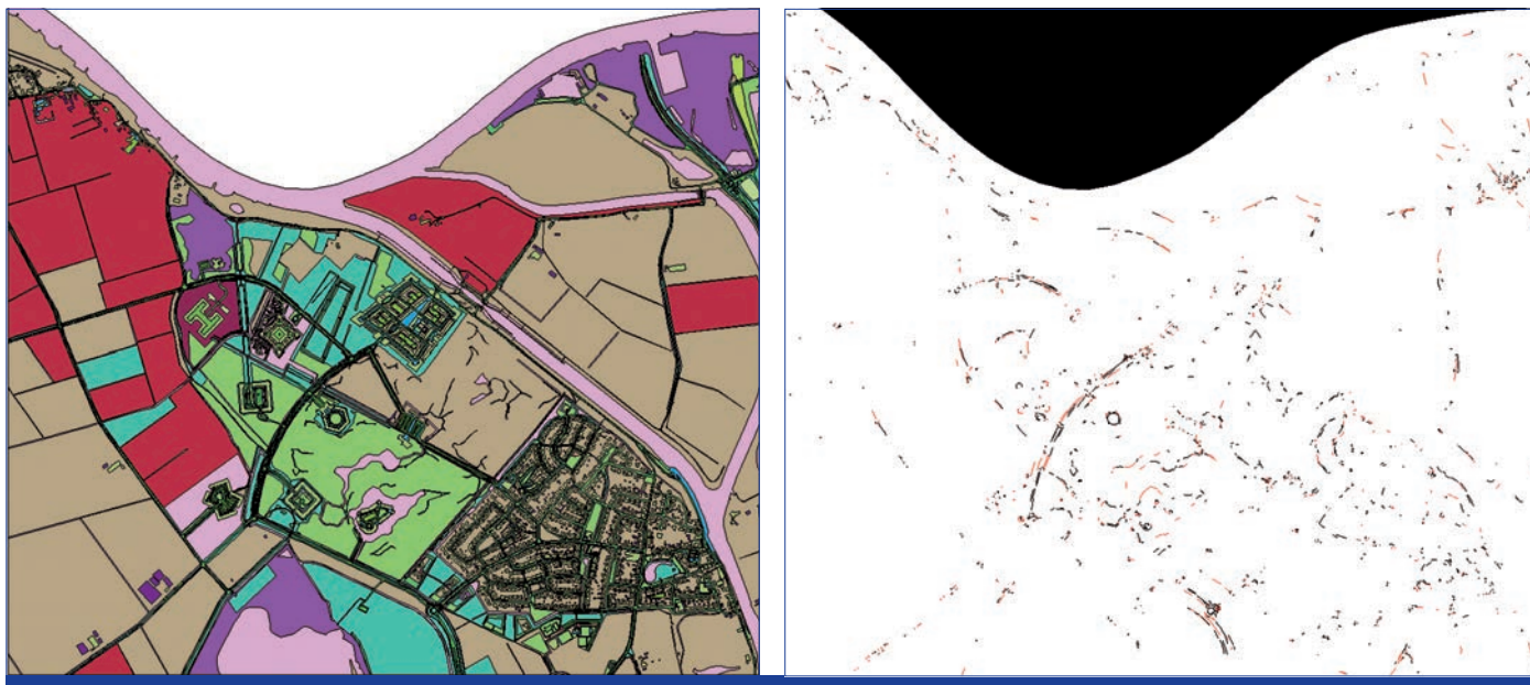
Fig. 6 Detectie van gaten en overlap in de BGT-testdata. Het grootste gat dat door onze tool gevonden werd, was zo'n 5 cm breed.
